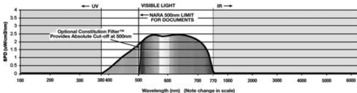
NoUVIR FIBER OPTIC LUMINAIRE SPECTRAL POWER DISTRIBUTION
